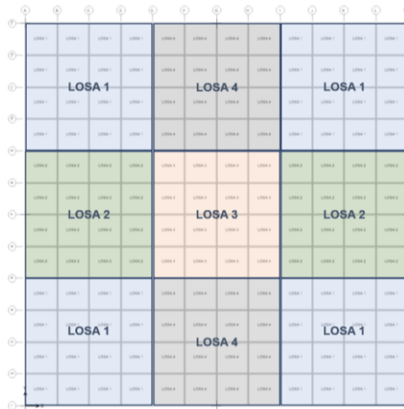
Figura 3.25. Zonificación de la losa
