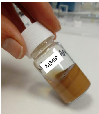
Figura 16. MMIP al finalitzar la polimerització.
