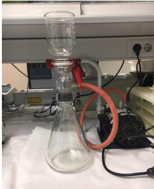
Figura 18. Muntatge del sistema de filtració al buit per a la neteja del MNIP.
