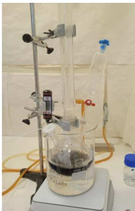
Figura 13. Muntatge per a la síntesi de les MNPs.
