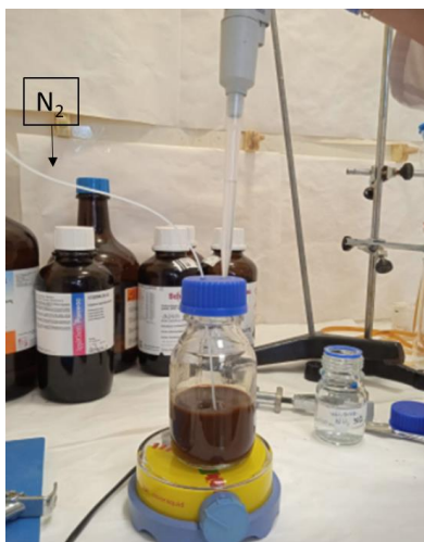
Figura 14. Muntatge per a la vinilització de les MNPs.
