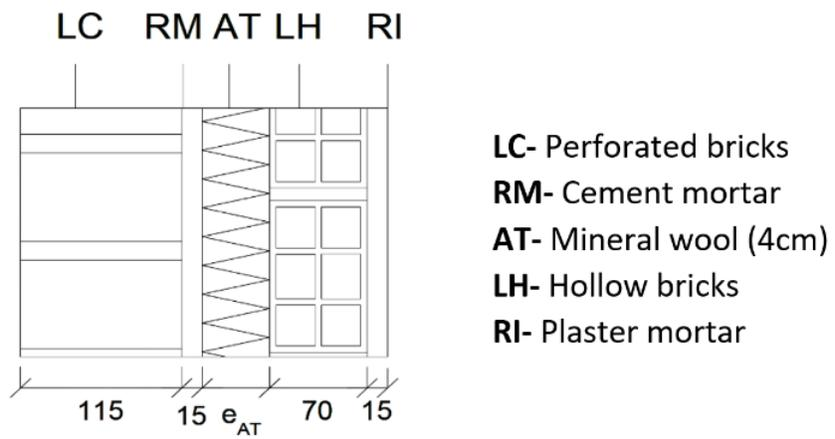
**Figure 3.5.** Double layer brick façade.
