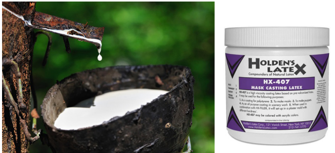
Fig. 1.12. Esta imagen ilustra el material en bruto al ser extraído del árbol de caucho y a su derecha el látex manufacturado que utilizamos en la gran mayoría del proceso latexgráfico para elaborar nuestras matrices
