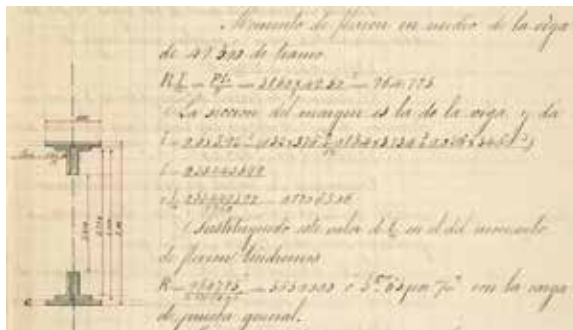
Figura 24. Determinación del momento de inercia y cálculo de la tensión de trabajo en llos cuchillos, según la fórmula de Navier. Proyecto del Puente del Barranco de la Fuente. Antonio Arriete, ingeniero. Archivo General de la Administración, signatura 04/087/ 25-07041
