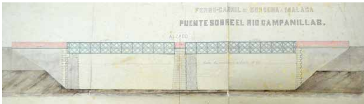
Figura 8: Puente sobre el río Campanillas, cerca de Málaga. 204 m de luz, 42 m de luz en dos tramos rectos continuos sobre pila central y estribos de fábrica. Archivo Histórico Ferroviario, signatura A-0012-003
