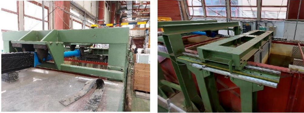
Figura 3.19. Sistema de generación del oleaje. Fuente: LPC-UPV
