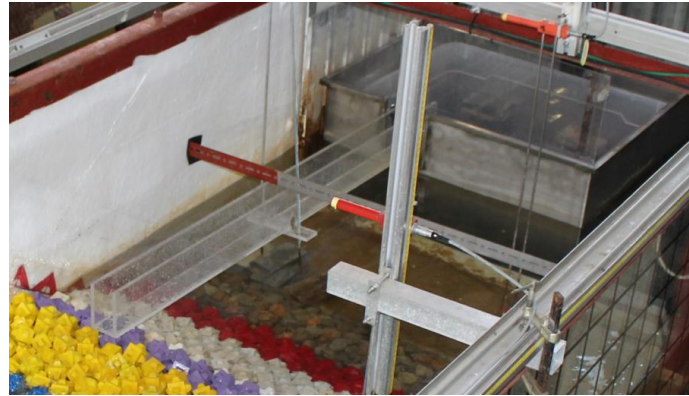
Figura 3.24. Equipo de captación de rebase. Fuente: Proyecto ESBECO LPC-UPV
