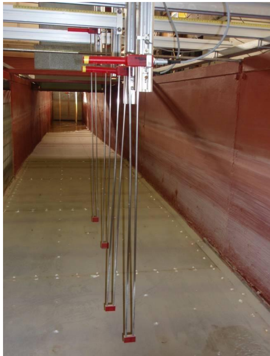
Figura 3.21. Sensores de nivel en el canal del LPC. Fuente: LPC-UPV
