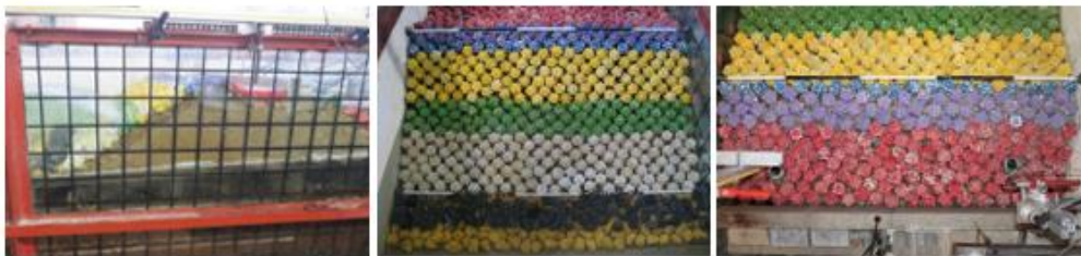
Figura 3.30. Modelo de cubipodos monocapa construido. Vista de perfil, talud frontal y coronación. Fuente: Proyecto ESBECA LPC-UPV
