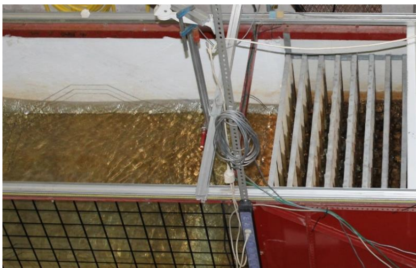
Figura 3.20. Disipador de energía en el canal LPC-UPV. Fuente: LPC-UPV
