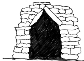
Arco formado por dos dovelas
