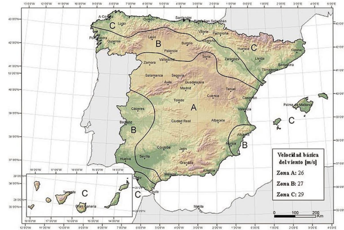
Ilustración 22. Mapa de isostacas para la obtención de la velocidad básica fundamental del viento V_{b,0} . (Fuente: IAP-11)
