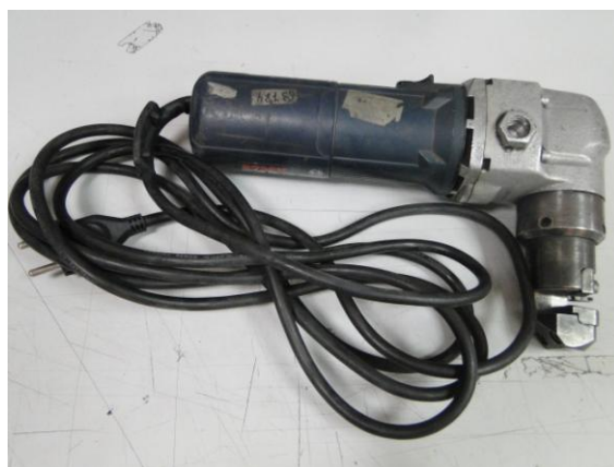
Figura 6.1: Imagen de la troqueladora industrial Bosch GNA 3,5, utilizada para cortar inicialmente la banda.
