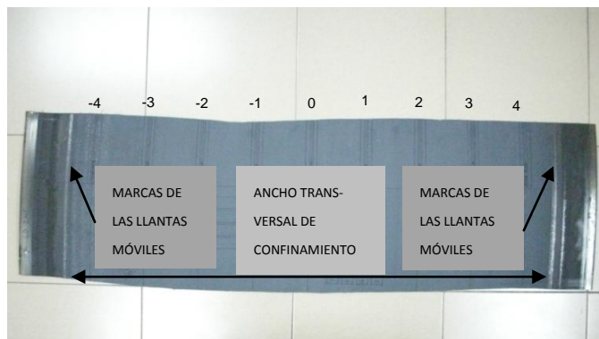
Figura 6.2: Macro-muestra de la banda Hazelett DZ, perteneciente al carro inferior, extraída mediante la troqueladora industrial y posteriormente marcada. Tal y como se puede observa se referencian todas las posiciones del estudio, las marcas de las llantas móviles y el ancho de confinamiento del molde.
