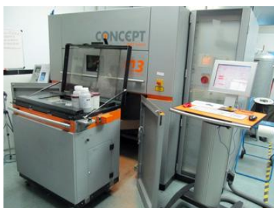
Figura 56: Izquierda: M3-linear con el módulo de SLM extraído de la máquina antes de introducir el polvo en los contenedores y fijar la placa de fabricación a la máquina. Derecha: Placa de fabricación anclada mediante 4 tornillos, alrededor se han colocado bloques de aluminio de relleno para minimizar la cantidad de polvo necesario en la fabricación. En la parte derecha de dicha imagen se puede ver el contenedor de polvo todavía vacío de polvo metálico.
