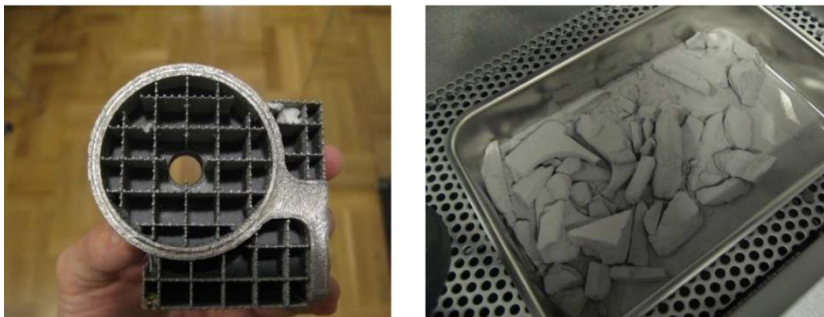
Figura 3: Izquierda; Pieza fabricada en Ti6Al4V con sus soportes tipo 1. Derecha: Restos de soportes semisinterizados. Cortesía AIMME.
