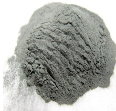
Figura 28: Izquierda: Esquema del proceso de atomización por gas [14]. Derecha: Muestra de polvos de CoCrMo ASTM F75 fabricado mediante atomización por gas.
