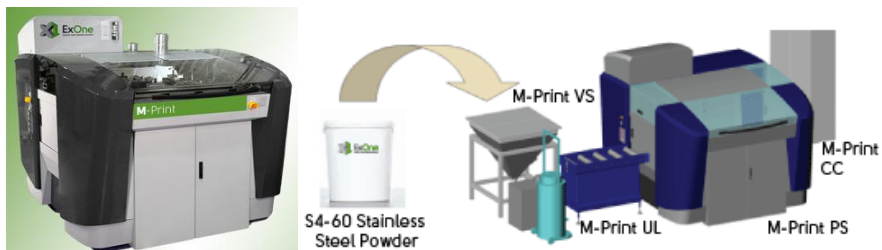
Figura 104: Tecnología inkjet, fabricante voxeljet. Izquierda: imagen del modelo M-print. Derecha: Esquema de la disposición de elementos auxiliares. (Ref. http://www.exone.com/ ).
