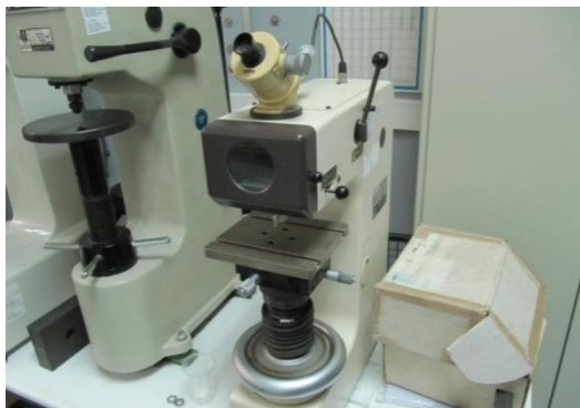
Figura 19: Durómetro Wolpert.. Cortesía AIMME.
