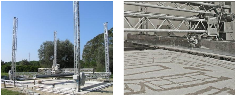
Figura 109: Izquierda: Tecnología D-SHAPE. Derecha: Detalle de fabricación.
