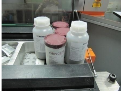
Figura 57: Botes de polvo de CoCrMo con 5Kgr de polvo cada uno de ellos.
