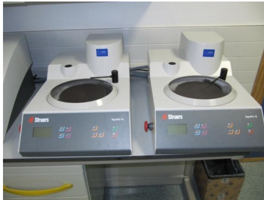
Figura 18: Equipo de preparación superficial de las muestras marca Struers, modelo tegrapol-1. Cortesía AIMME.
