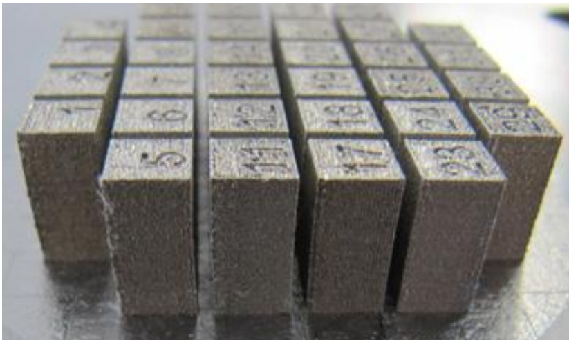
Figura 61: 32 probetas de CoCrMo ASTM F75 fabricadas en 32 configuraciones distintas de procesado mediante SLM. Vista lateral.
