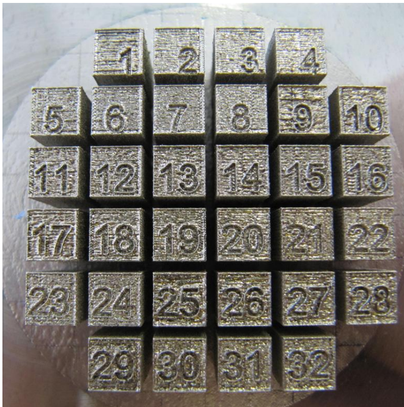
Figura 62: 32 probetas de CoCrMo ASTM F75 fabricadas en 32 configuraciones distintas de procesado mediante SLM. Vista planta.
