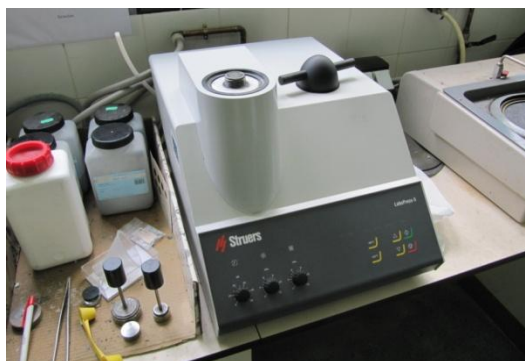
Figura 17: Equipo de embutición de muestras marca Struers, modelo labopress – 3. Cortesía AIMME.
