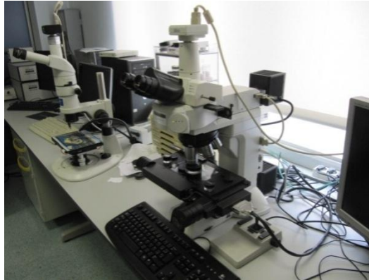
Figura 20: Microscopio óptico Nikon, modelo eclipse LV100. Cortesía AIMME.
