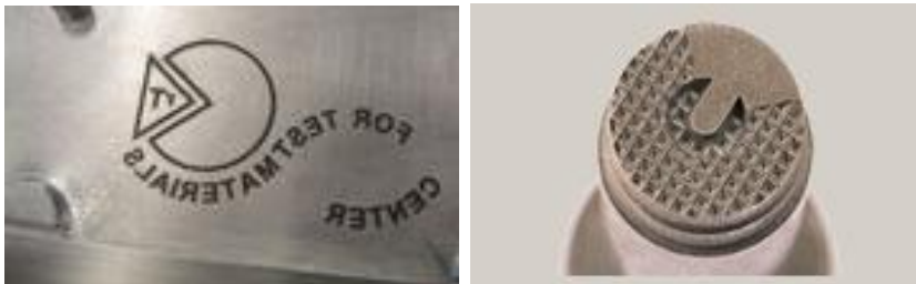
Figura 12: Ejemplos de erosión 3D (imagen izquierda) y marcado láser 2D (imagen derecha).Figura: Ejemplos de erosión 3D (imagen izquierda) y marcado láser 2D (imagen derecha).
