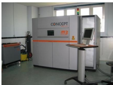
Figura 106: Tecnología SLM, fabricante Concept láser GmbH. Izquierda: imagen del modelo M3-linear. Derecha: Esquemas proceso( http://www.concept-láser.de/ ).
