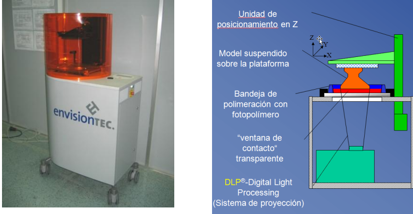
Figura 100: Tecnología Digital light processing (DLP) fabricante Envisiontec. Izquierda: imagen del modelo Perfactory. Derecha: Esquema de proceso. (Ref. http://www.ensiviontec.de ).
