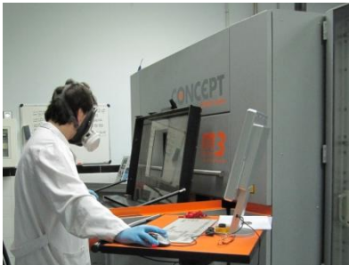
Figura 58: Izquierda: Técnico realizando las primeras pasadas del repartidor o coater para planear la superficie de polvo enrasándolo con la placa de fabricación. Derecha: Placa de fabricación enrasada con el polvo metálico de la aleación de CoCrMo para empezar el proceso de fabricación.
