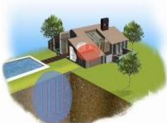
Figura 3.5: Funcionamiento de la BGC en invierno
