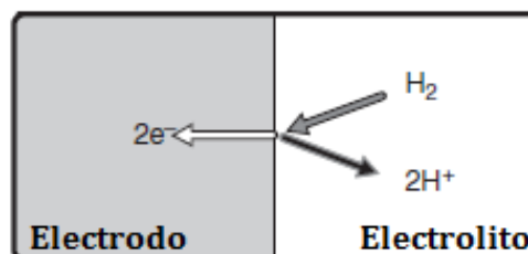
Figura 29. Intercambio electrónico superficial en la reacción anódica de una PEMFC (HOR).
