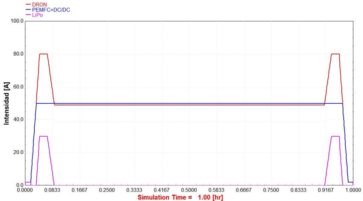
Figura 47. Modelado de la respuesta del sistema híbrido "PEMFC + LiPo" (1h).
