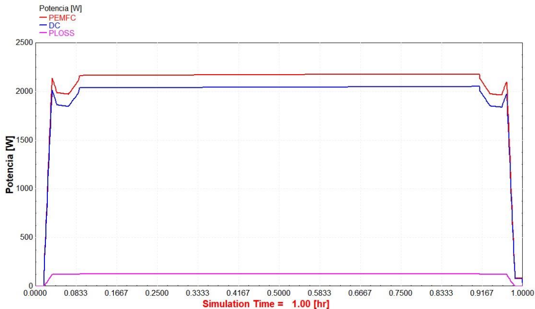
Figura 54. Pérdidas de potencia en el convertidor DC/DC (1h).
