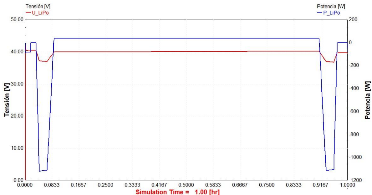
Figura 52. Respuesta dinámica de la batería LiPo (1h).
