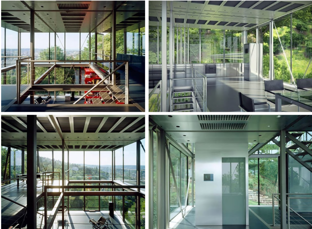
84 Vistas interiores, comunicación vertical, zona de cocina y comedor, zona opaco en el interior y detalle de la estructura mediante cruces con tirantes. [Onekindesign]
