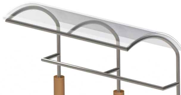
Ilustración 44. Montaje de paneles. Fuente: propia.
