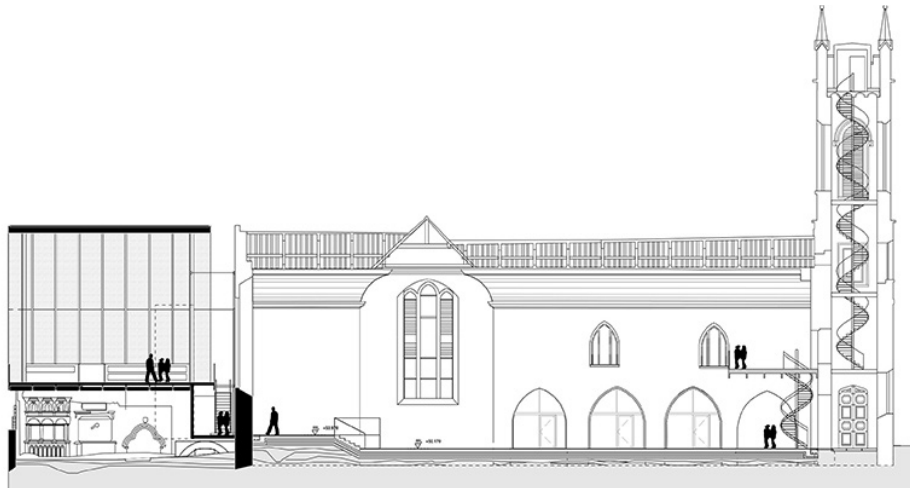
Figura 16. Sección del edificio mostrando las nuevas estructuras de acceso. Tomada de sitio web miesarch.com, 2021.
