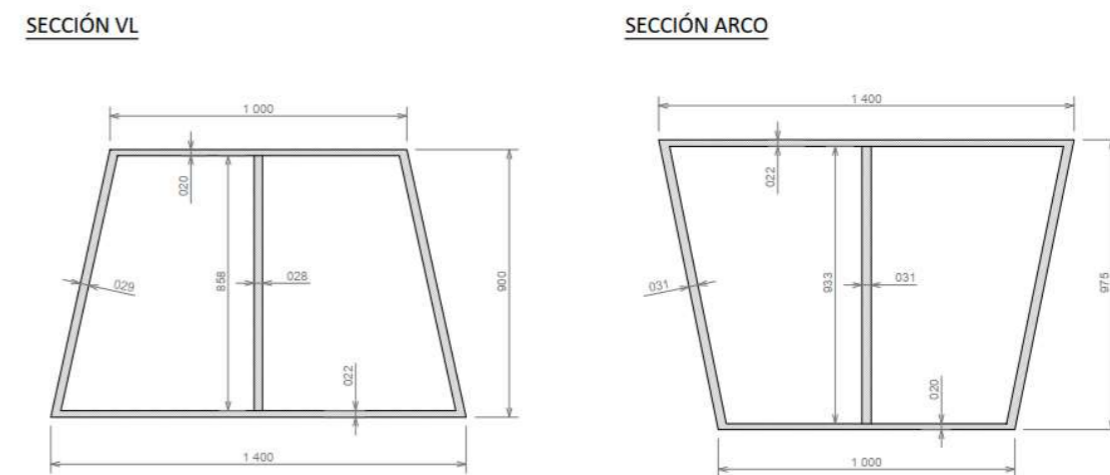
Figura 21 - Secciones consideradas para los arcos y las vigas longitudinales (fuente: elaboración propia)
