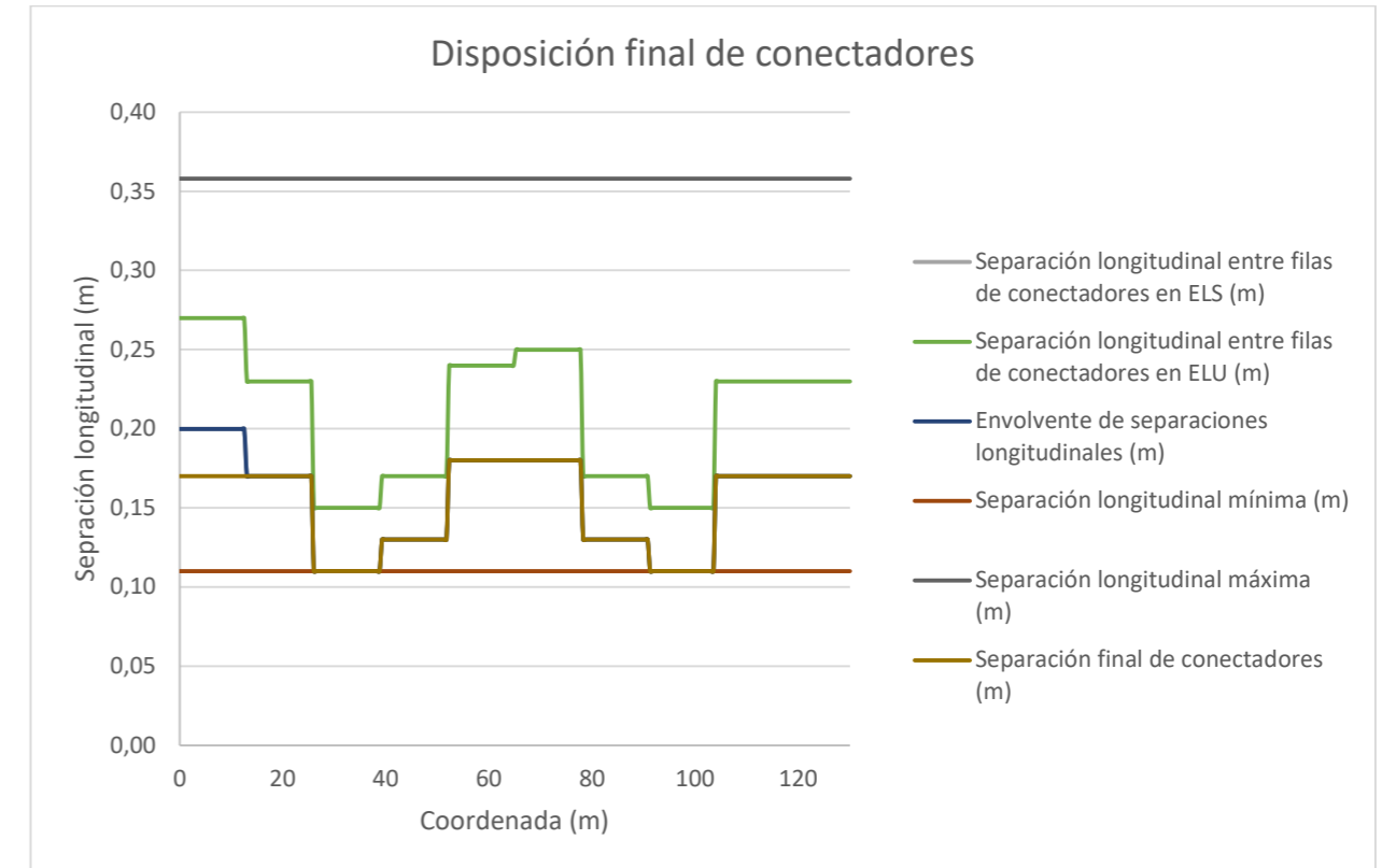
Figura 179 - Separaciones longitudinales ente conectadores y comprobación de las separaciones limites en las vigas longitudinales (fuente: elaboración propia)
