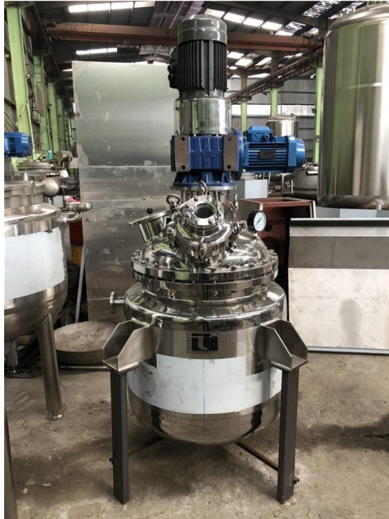
Ilustración 14. Reactor con chaqueta térmica y agitador (Nanjing Bang Win Imp & Exp Co., Ltd.)
