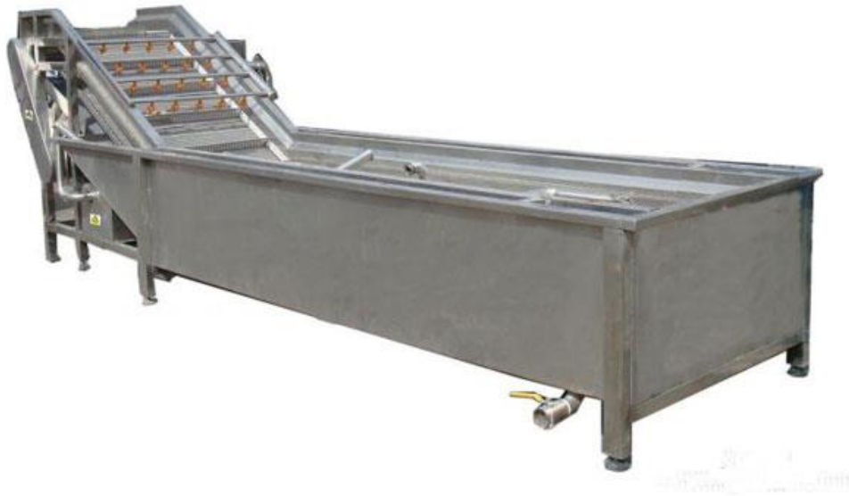
Ilustración 11. Máquina para la limpieza de la fruta AGICO
