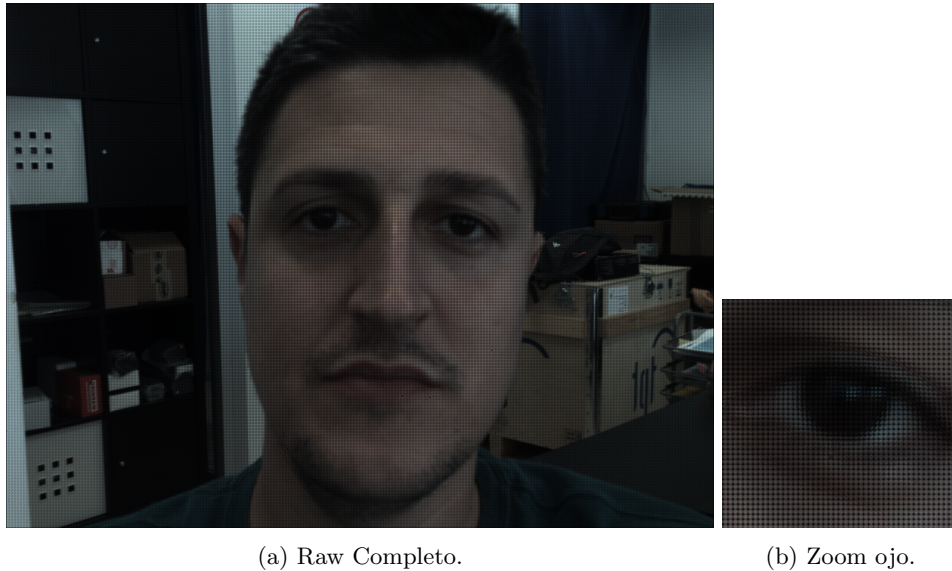
Figura 4.4: Ilustra una imagen completa con los valores directamente leídos del sensor (sin tratamiento alguno) conocido como RAW .
