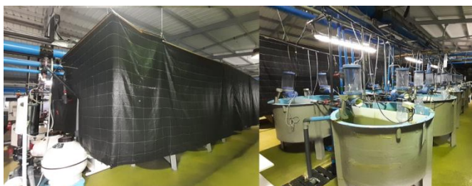
Figura 5. Zona de experimentación con los tanques dotados de los comederos de auto-demanda.
