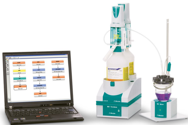
Figure 3.22. Montaje experimental 859 Titrotherm para la realización de las valoraciones termométricas de Metrohm compuesto por: software tiamo, bureta Dosino y termistor Thermoprobe 6.9011.020.
