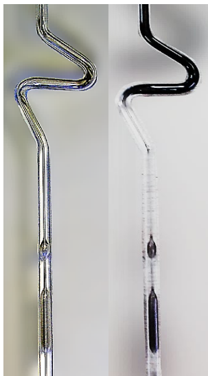
Figure 3.5. Foto del tubo tipo Houillon del SimpleVIS+ nuevo (izquierda) y tras ser usado en muestras de aceites lubricantes de motor usado (derecha).
