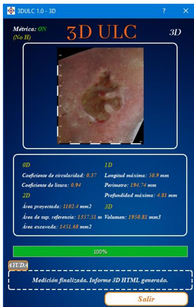
Figura 5.23. Presentación de resultados en el módulo “3D” del software 3DULC: Interfaz gráfica de usuario con la que concluye el procedimiento de medición.
