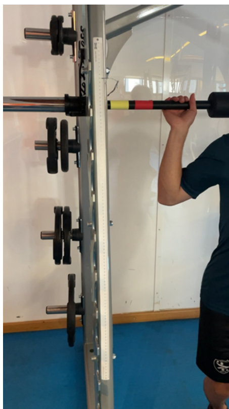
Figura 5.4: Mètode de validació format per una cinta mètrica i un fil d'aram
