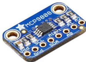
Fig. 3.6 Sensor de temperatura MCP9808
