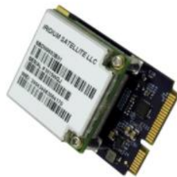
Fig. 2.12 16130 Adaptador Mini-PCle (Iridium)
