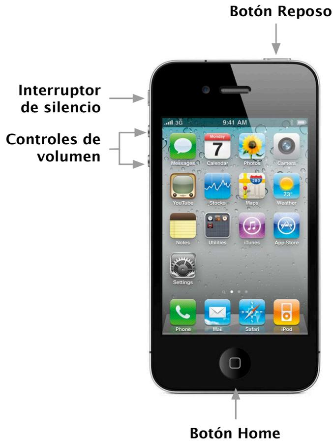
Figura 1.2: Esquema de los controles de un dispositivo *iOS*.
