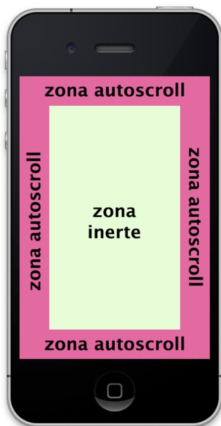
Figura 14.5: Detalle de la zonas inerte y de autoscroll.
