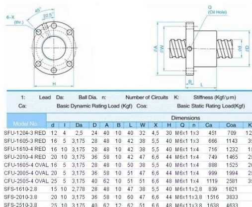
Figura 28. Tipos tuerca rosca redonda
