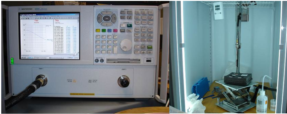
Figura 3.5. Analizador de redes E8362B de Agilent y sonda coaxial 85070E de Agilent.
