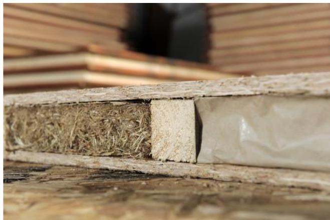
Figura 24: Tablero aislante compuesto por listones de madera, colchones radiculares y tablero de madera (Franco 2018)
