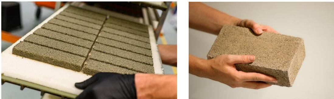
Figura 20: Ladrillos de biocemento durante proceso de fabricación (izquierda) y aspecto final (derecha) (“BioMason-ESP” 2012)
