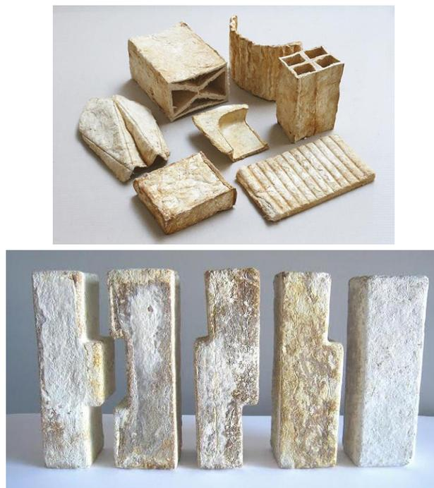
Figura 25: bloques de ladrillos elaborados con micelio (“Micelio, El Material de Construcción a Base de Hongos.” 2019)
