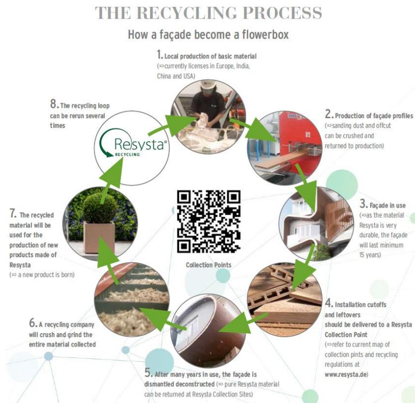
Figura 31: Reciclaje del producto llevado a cabo por la empresa. (RESYSTA GmbH 2018)
