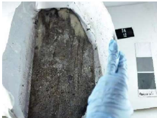
Figura 119. Madera húmeda y presencia microbiológica, LEACH, 2016 902
