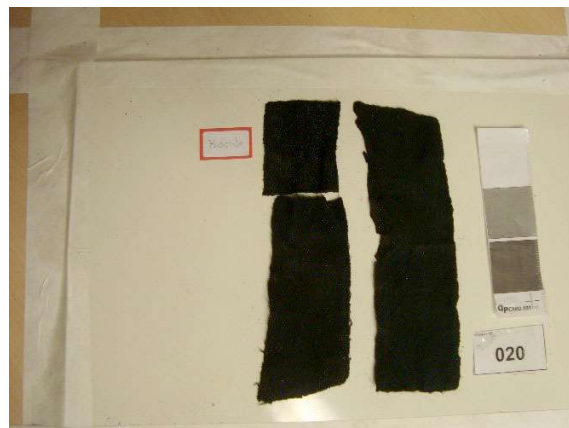
Figura 120. Prueba con biocida en tejido mojado: aplicación en fragmento menor, laboratorio del navío Almirante Maximiano, 2017 903
