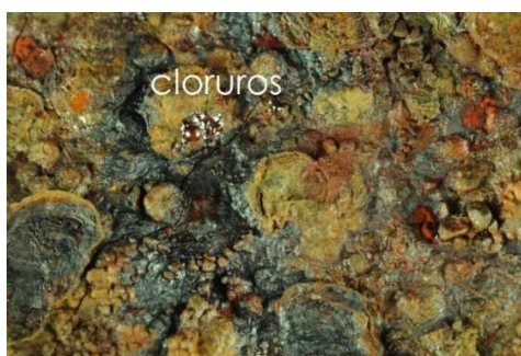
Figura 26. Presencia de cloruros en hierro arqueológico (20x) 448
