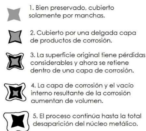
Figura 25. Concreción en el hierro arqueológico 437
