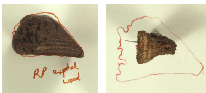
Figura 16. Degradación de material orgánico en el secado 311
