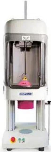
Figura 2 - Reómetro capilar
