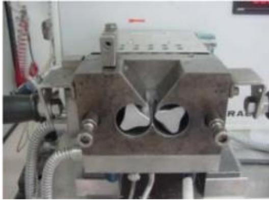
Figura 5 - Cámara del Brabender con dos husillos rotatorios
