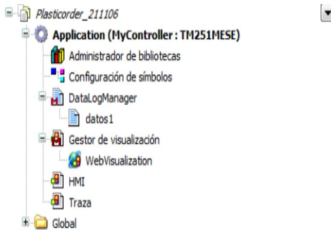
Figura 54 - Estructura de DataLogManager y del Gestor de visualización
