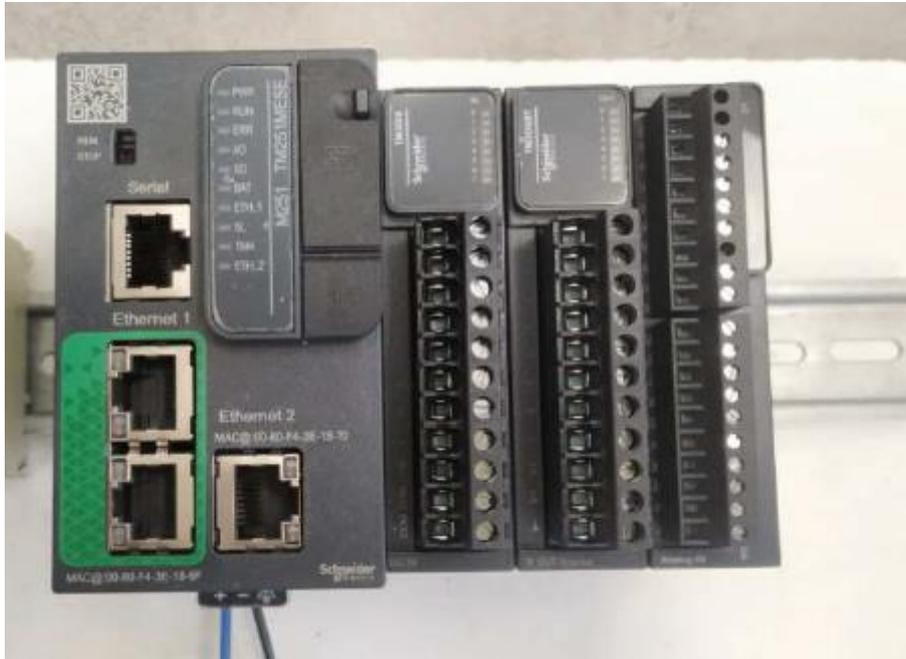
Figura 25 - Montaje del autómata y los módulos E/S
