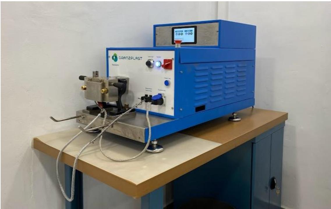
Figura 85 – Reómetro terminado
