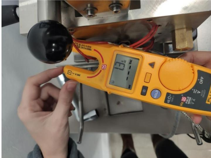
Figura 82 – Comprobación de las resistencias del cabezal
