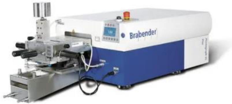
Figura 4 - Reómetro de torsión
