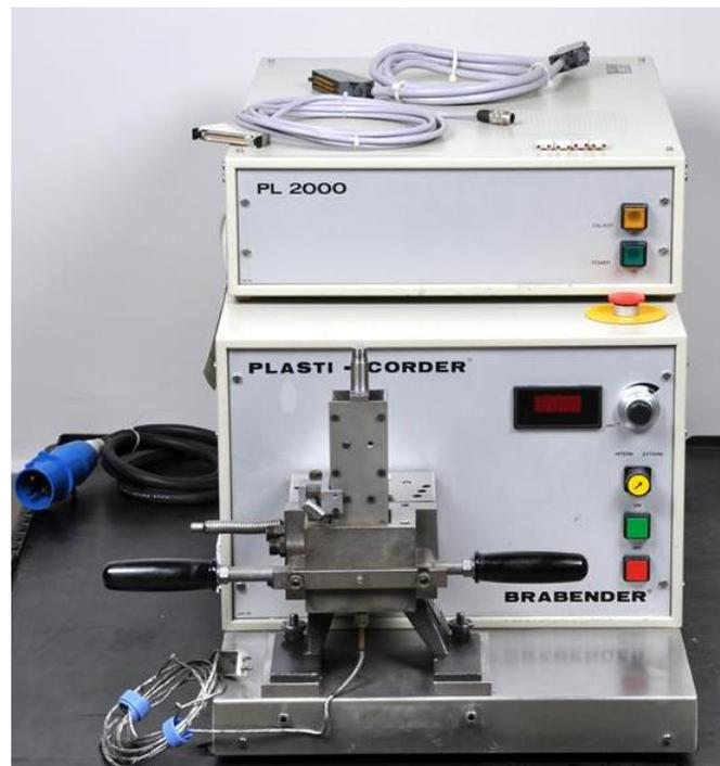
Figura 13 - Reómetro antes del reacondicionamiento
