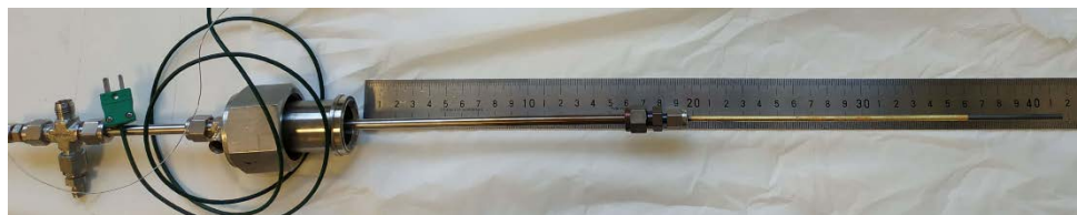
Figura 4.7. Fotografía del sistema empleado para la utilización de membranas de oxígeno en el reactor de ATR.
