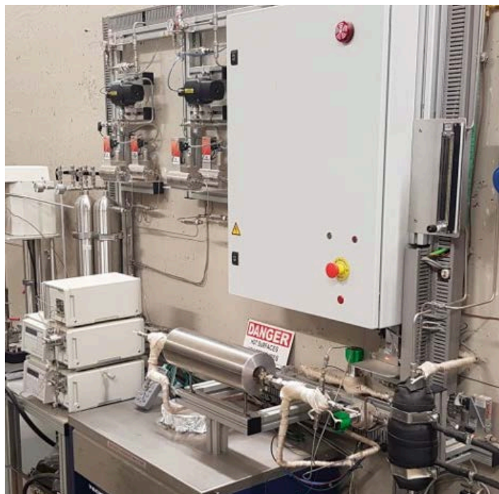
Figura 8.3. Sistema de reacción de alta presión, con montaje del reactor de membrana de alta presión.
