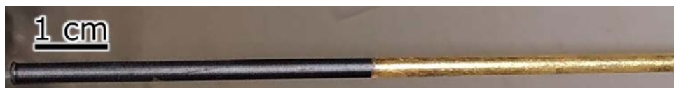
Figura 4.2. Detalle del recubrimiento de oro fuera de la longitud efectiva de una membrana de BSCF para su utilización en el reactor de ATR.
