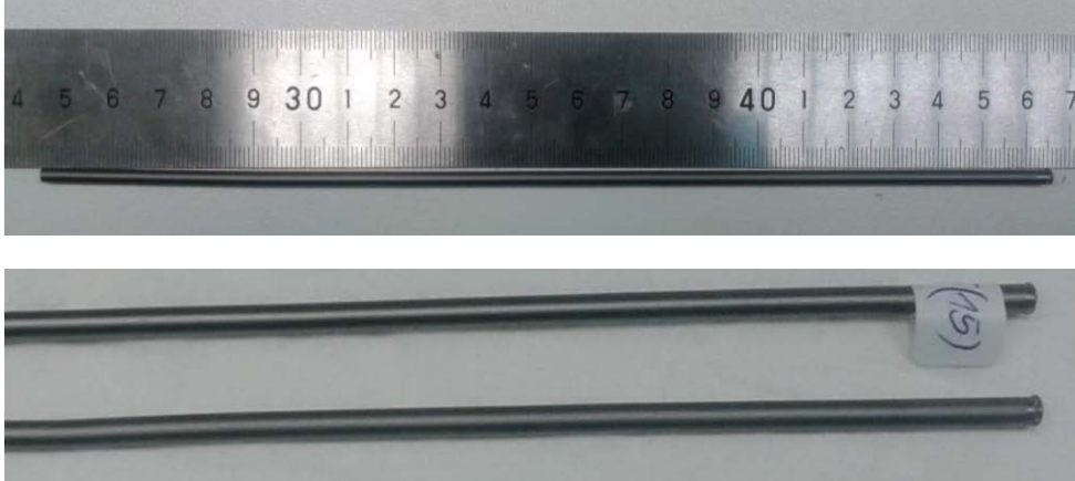
Figura 7.1. Fotografías de los capilares de BSCF empleados. La imagen inferior muestra en detalle la parte del sellado en uno de los extremos de los capilares.
