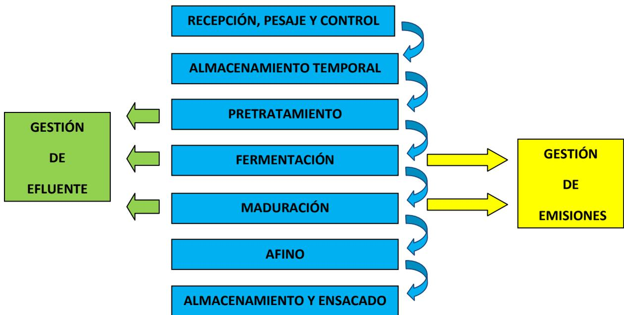
**Figura 7:** Esquema de una planta de compostaje
