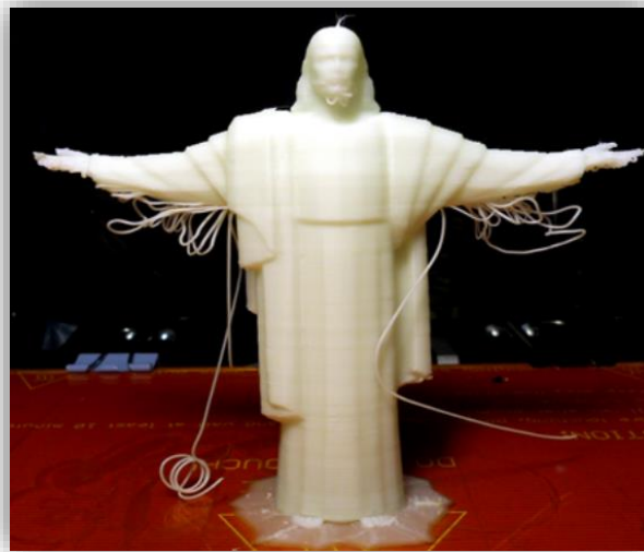
Ilustración 61. Errores de impresión causados por voladizos [13]
