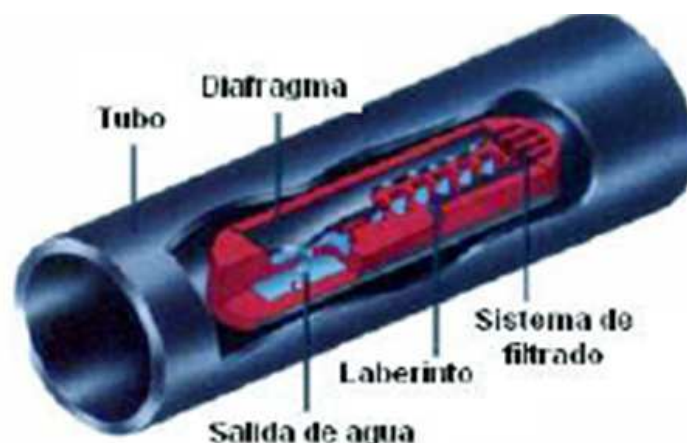
Figura 24. Gotero auto compensado (Liotta M.)
