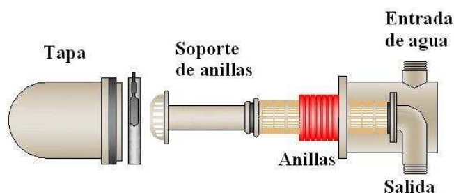
Figura 58. Filtro de Anillas estructura interna
