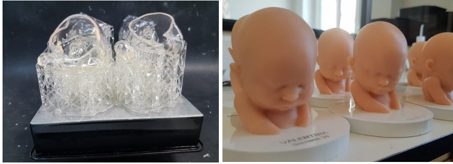
FIGURA 133 MOLDE IMPRESO SLA (IZQUIERDA) Y MODELO DE SILICONA (DERECHA) (2019)
