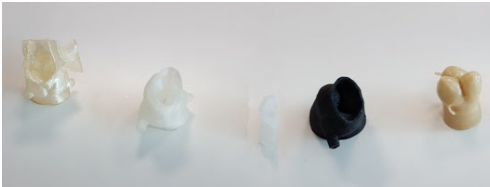
FIGURA 94 EXPERIMENTOS CON DIFERENTES MATERIALES Y TÉCNICAS PARA CREAR VÁLVULAS FLEXIBLES (2017)
