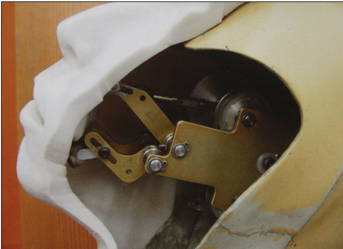
Fig. 24 Detalle del mecanismo interno de la cabeza y la silicona que recubre.
