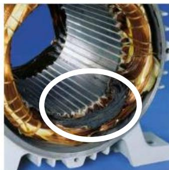
**Figura 2.9:** Deterioro del estator por cortocircuito entre bobinas.
