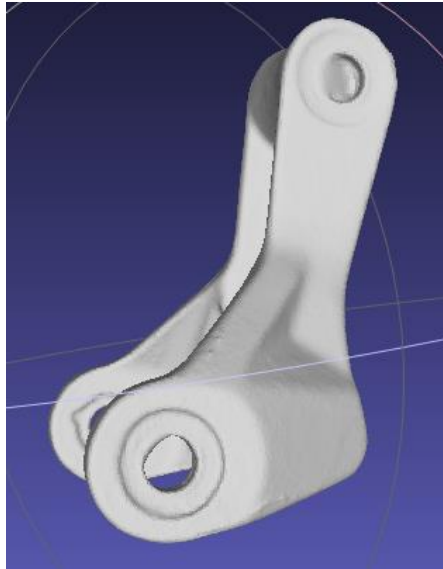
Figura 28. Pieza reconstruida en su totalidad, gracias al programa “MeshLab” y su herramienta de reconstrucción de superficies.
