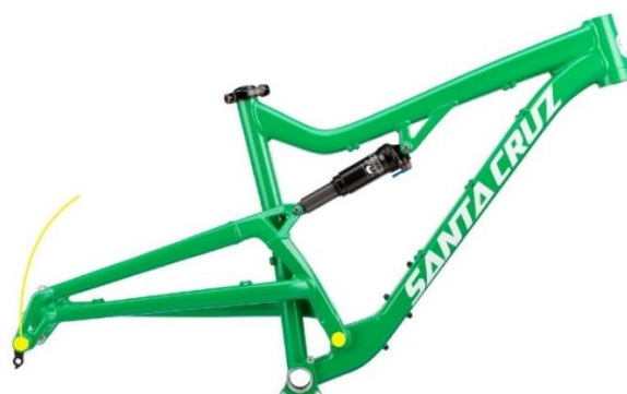
Figura 14. Cuadro de doble suspensión “Santa Cruz” con configuración monopivote y amortiguador de aire.
