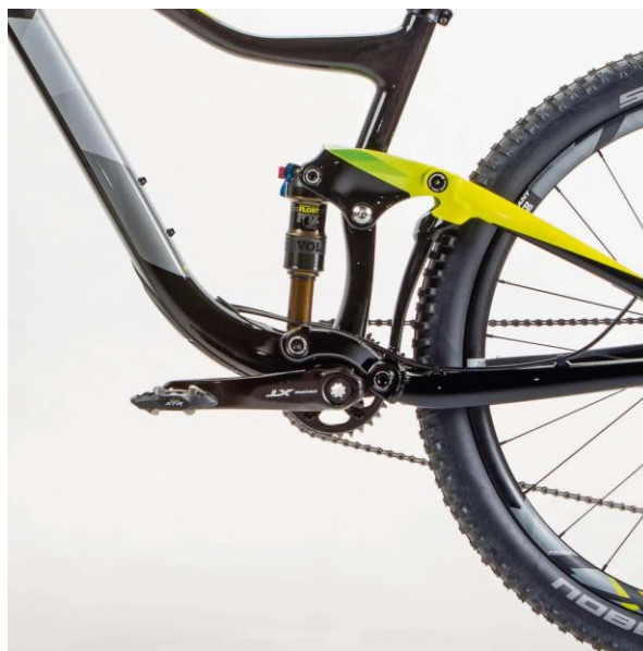
Figura 17. Cuadro de doble suspensión “Giant Trance 29” con configuración Pivote virtual, sistema “MAESTRO” patentado por la propia marca.
