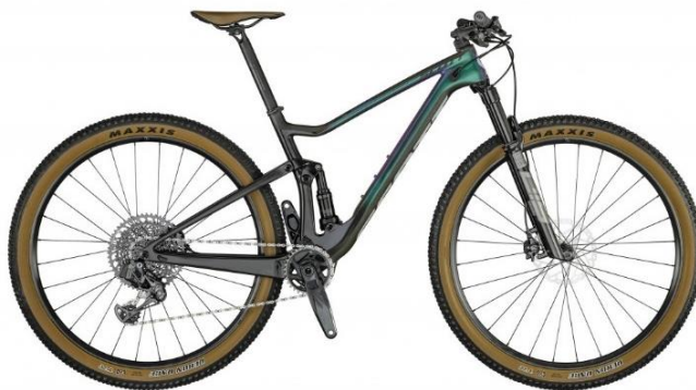
Figura 22. “Scott Spark RC900” con sistema monopivote articulado.
