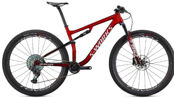
Figura 21. “Specialized Epic Pro” con sistema monopivote articulado.
