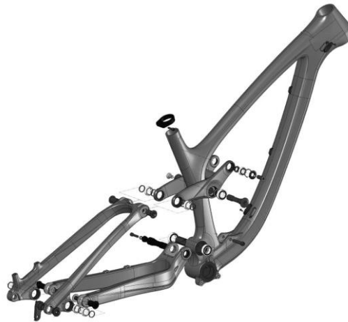
Figura 13. Elementos de un sistema de doble suspensión [8].
