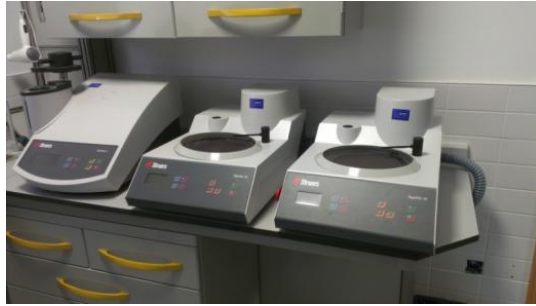
Imagen 2-9. Equipos empleados para la preparación de las muestras previa a la inspección en microscopio óptico.
