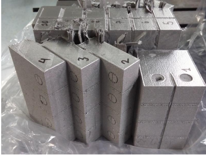
Imagen 2-7. Posición y orientación durante la tercera bandeja de fabricación donde se pueden observar las muestras en la posición vertical y horizontales.
