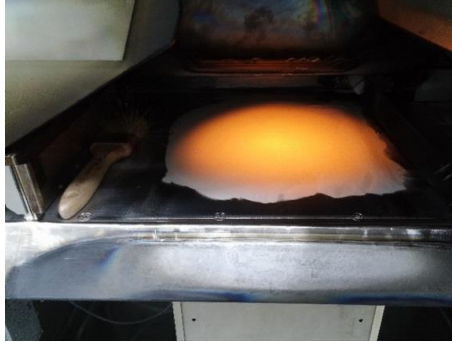
Imagen 2-2. Fotografía tomada momentos después de la apertura de puertas de la máquina donde se puede apreciar el lecho de polvo, dentro del cual se encuentran las muestras fabricadas. A partir de este instante comienza la salida de la bandeja de fabricación.
