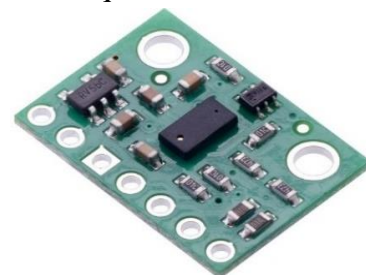
Imagen 16. Sensor laser VL5310X. Fuente: pololu.com
