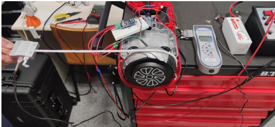
Imagen 20. Montaje para medición de par.
