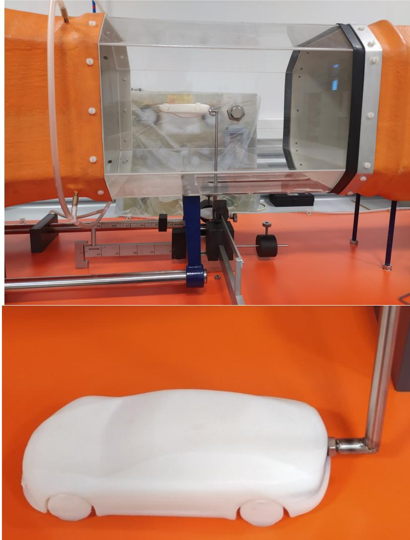
**Figura 3.14:** Tesla Model S con su varilla e introducido en el túnel de viento subsónico.
