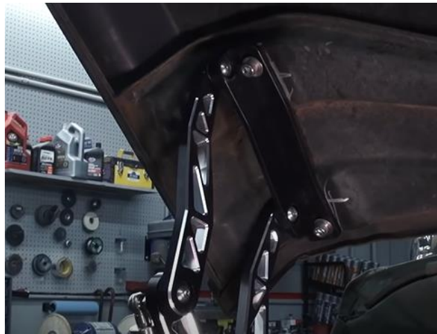
Figura 8. Bisagra profesional instalada en un capó 8
