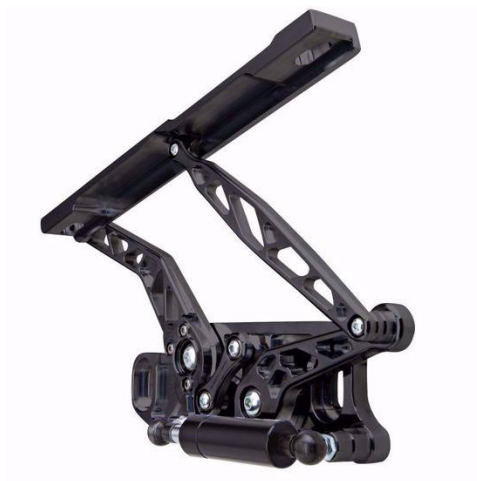
Figura 7. Bisagra profesional con resorte de gas de Ringbrothers 7
