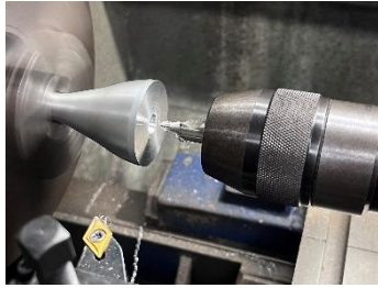
Figura 34 a) Punteado para el posterior taladrado
