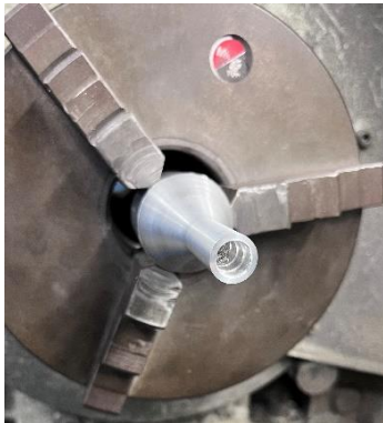
Figura 28 c) Resultado del proceso de taladrado progresivo en el aluminio
