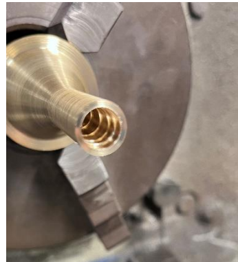
Figura 28 d) Resultado del proceso de taladrado progresivo en el latón
