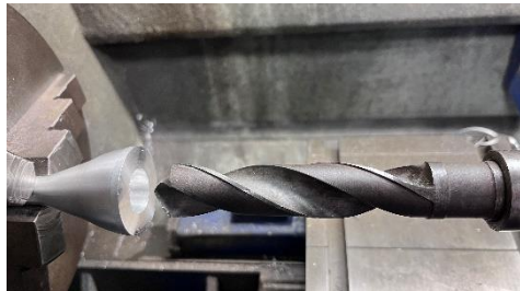
Figura 34 c) Taladrado con broca del 24
