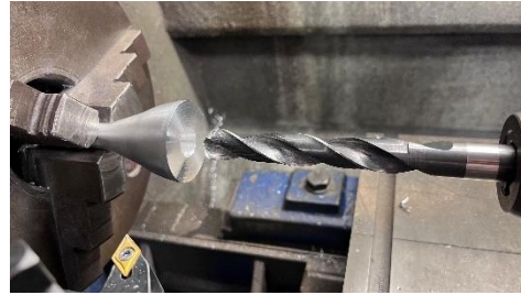
Figura 34 b) Taladrado con broca del 15
