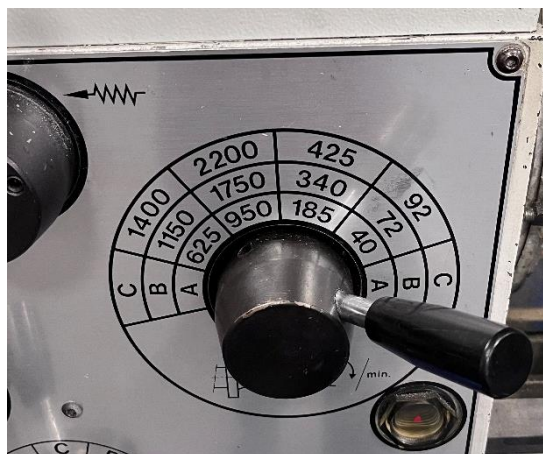
Figura 27 Posiciones de las velocidades en el torno manual
