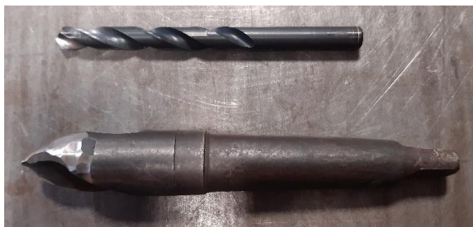
Figura 33 Broca modificada (abajo) comparada con una broca de M10
