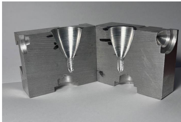
Figura 31 Bloque de aluminio con la geometría de la copa
