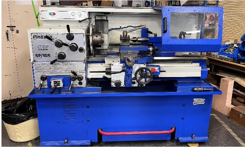
Figura 18 Torno manual Pinacho SP/165
