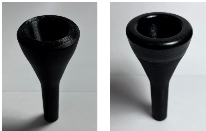
Figura 14 Impresión 3D del modelo CAD modificado
