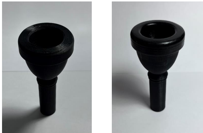
Figura 8 Impresión 3D de la modelo CAD
