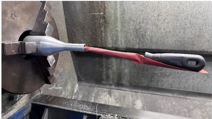
Figura 28 f) Proceso de lijado para un acabado adecuado
