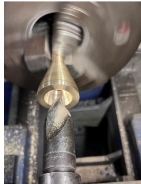
Figura 34 f) Último taladrado con geometría diseñada
