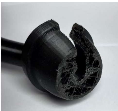
Figura 61 a) Vista en perspectiva de la sección del interior de la copa
