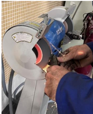
Figura 34 e) Desbastado de la broca para conseguir la geometría deseada
