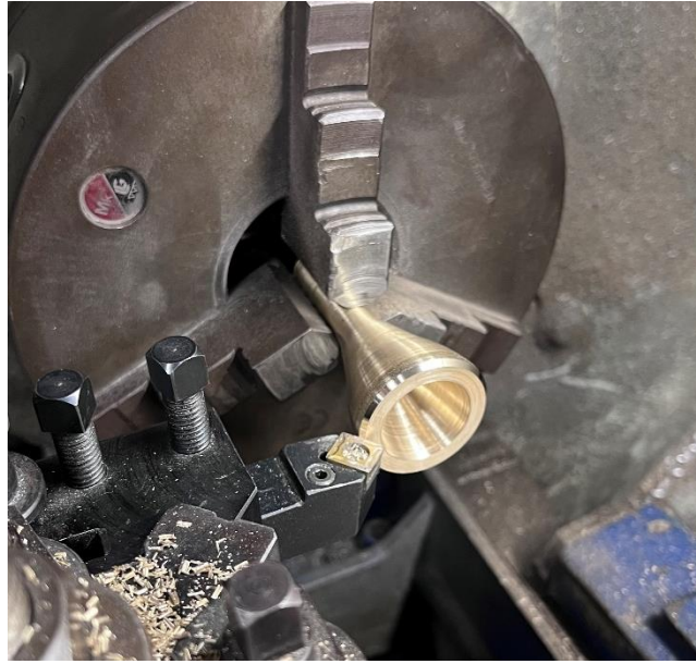
Figura 35 Mecnizado del chaflán del aro
