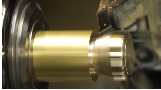
Figura 6 a) Aproximación al contorno final de la boquilla
