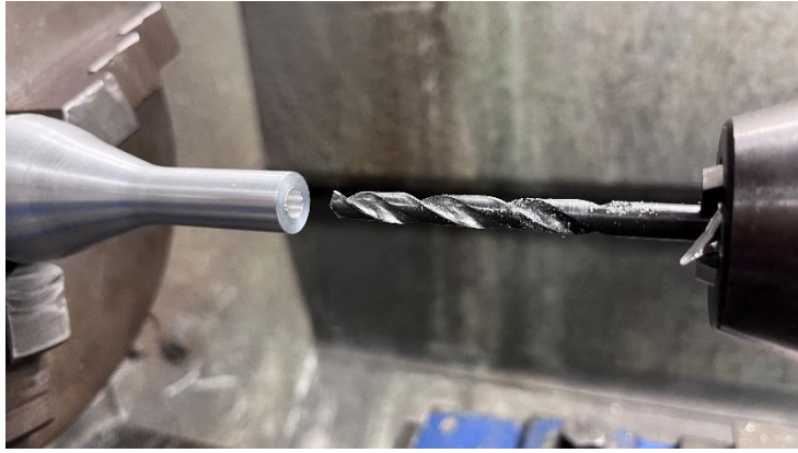
Figura 28 b) Proceso de taladrado progresivo
