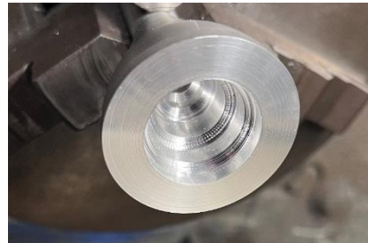
Figura 34 d) Resultado del proceso de mecanizado progresivo
