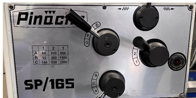
Figura 38 Selector de velocidades del torno manual
