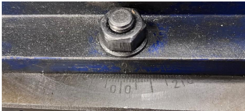
Figura 37 Ajuste del grado de inclinación de la herramienta
