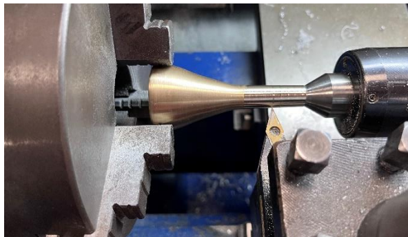
Figura 39 Proceso de mecanizado cónico del exterior del tudel
