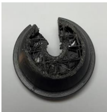
Figura 61 c) Sección transversal de la parte interna de la copa de la boquilla
