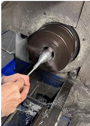
Figura 28 e) Proceso de limado del interior del tudel
