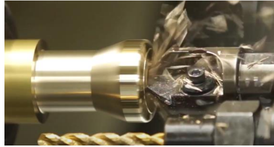
Figura 6 b) Proceso de avellanado interno
