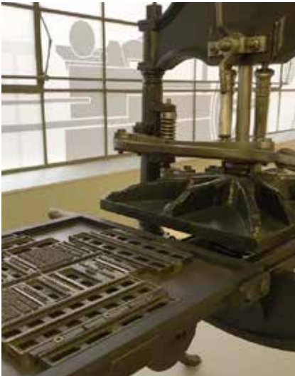
Fig. 10. Prensa de fundición. Imprenta Municipal. Madrid
