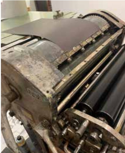
Fig. 38 Hoja sujeta en el rodillo impresor a través de las pinza hojas.
