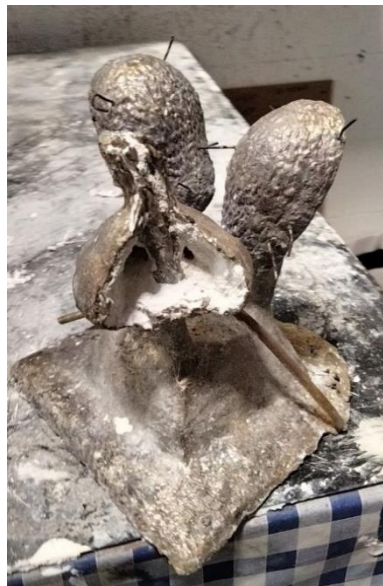
Fig 21. Capas de moloquita y sílice del molde.
