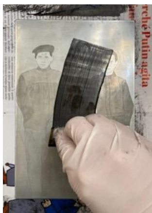
FIGURA 80: Proceso de entintado. Tinta aplicada con una rascleta.
