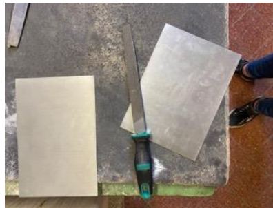
FIGURA 57: Biselado de las planchas con una escofina.
