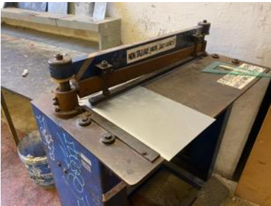
FIGURA 56: Guillotina para cortar las planchas de metal.
