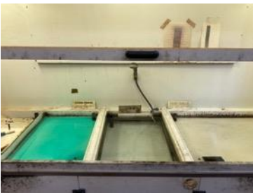
FIGURA 10: Diferentes ácidos para las técnicas indirectas del grabado.
