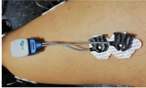
Fig. 48: Electrodo conectado al medidor inalámbrico.
