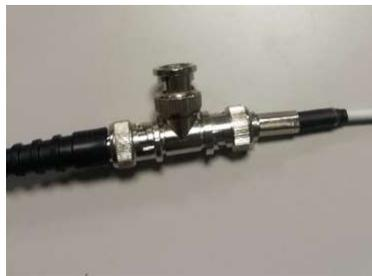
Fig. 41: Conexión física trigger Optitrack y Noraxon.
