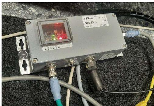
Fig. 31: Equipo de recepción y procesamiento del sensor de fuerzas.
