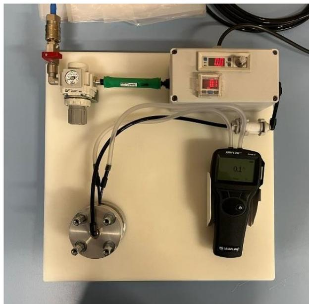
Figura 20.- Manómetro diferencial digital.
