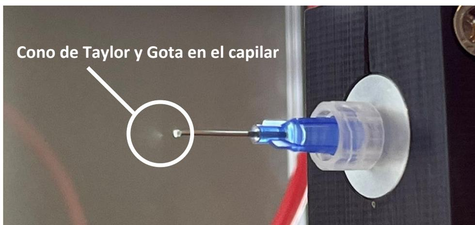
Figura 27.- Boquilla de extrusión de solución y cono de Taylor con voltaje de 12 kV y caudal de alimentación 0,32 mL/h.
