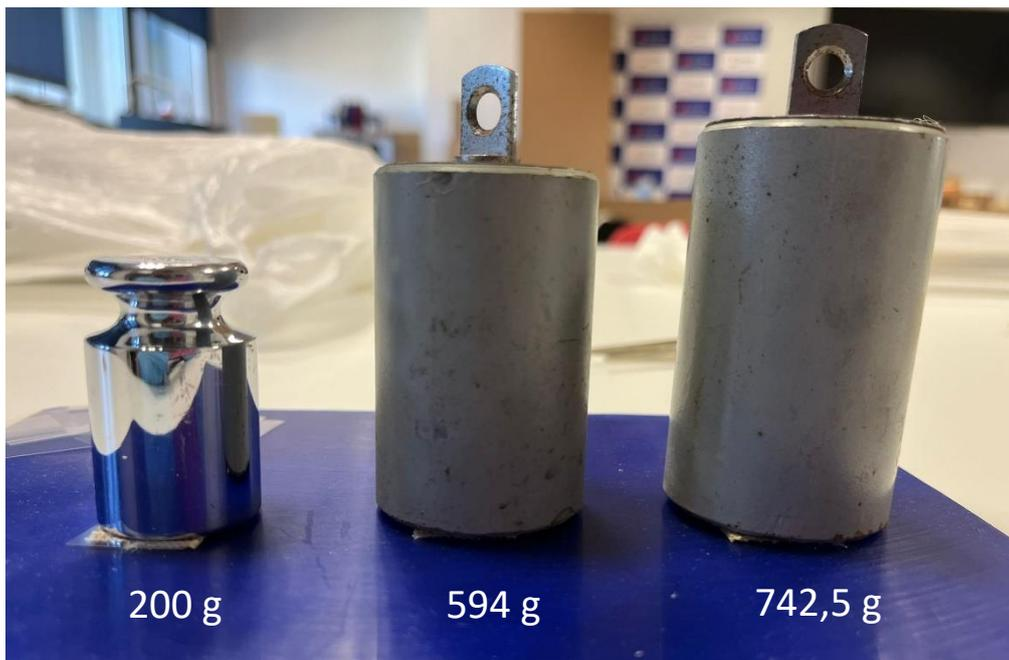
Figura 21.- Pesos utilizados en el ensayo de adherencia.
