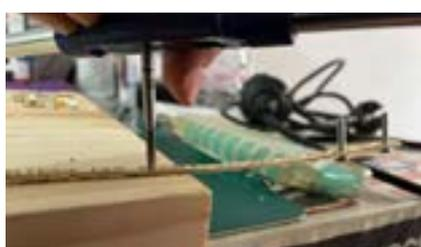
Figura 30: Fotografía ilustrativa del proceso de aplicación de desmoldeante.
