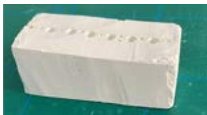
Figura 23: Lecho y paredes listas para vaciado de escayola del molde inicial para el positivado de las esferas.
