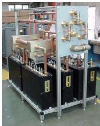
Patch panel with diplexer embedded for Bill Cuadro conmutador con multiplexor embebido
