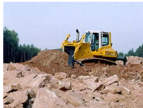
Figura 2.19: Tractor de oruga con cuchilla frontal. Fuente: Liebherr
