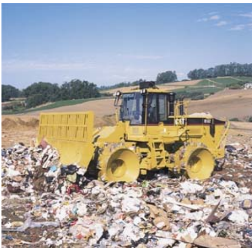
Figura 2.13.: Máquina para extender, compactar y triturar los residuos in situ. Marca Caterpillar Modelo 816F
