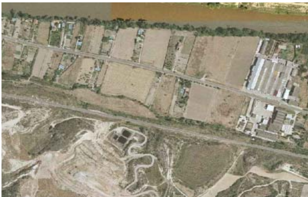
Figura 4.13: Ortofotografía de vertedero con sus correspondientes balsas de lixiviados a 340 metros del río Ebro. Ocasionalmente se denuncias fugas de lixiviados. Fuente: (SIGPAC. 2006)
