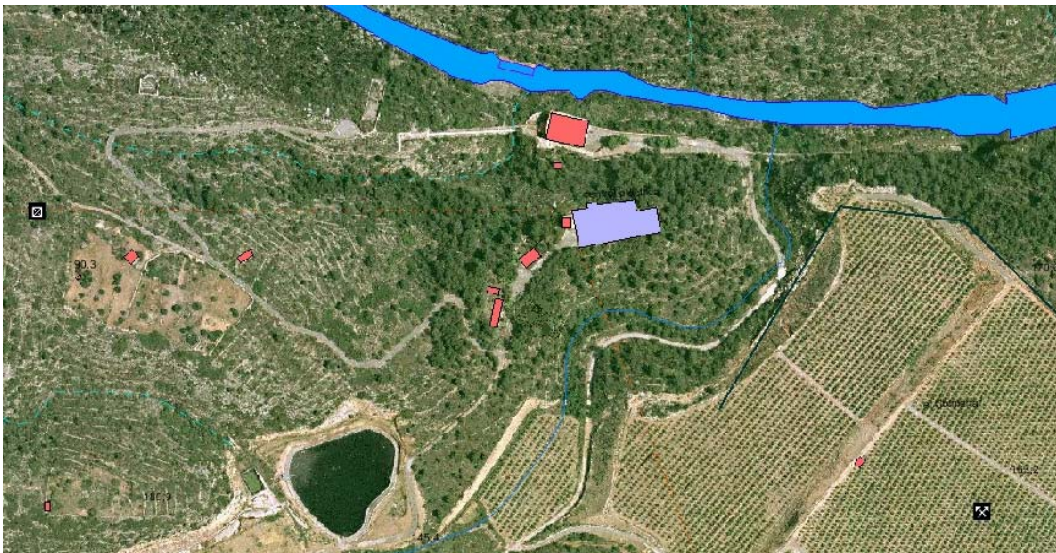
Figura XII.1: Ortofotografía de una balsa de lixiviados para una planta de compostaje a pocos centenares de metros de un río. Fuente: Cartografía Temática de la Comunidad Valenciana. Conselleria de Territorio y Vivienda. Generalitat Valenciana. http://orto.cth.gva.es
