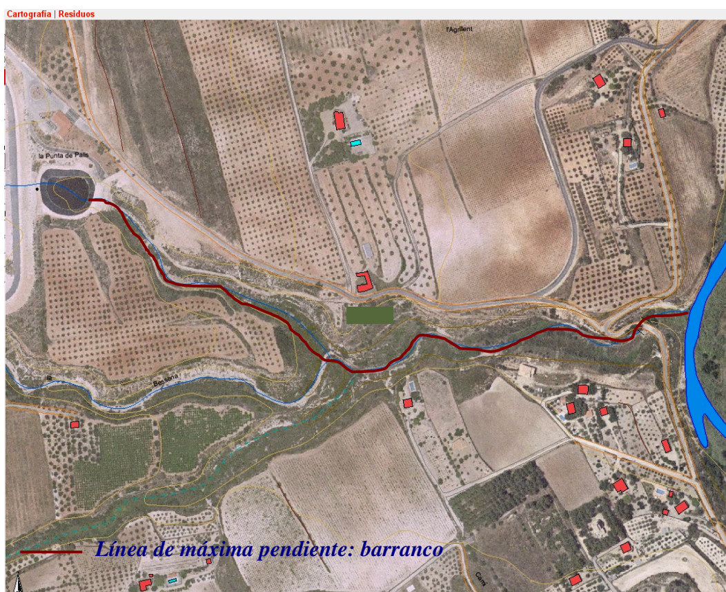
Figura 5.7: Ortofotografía de la balsa de lixiviados en un vertedero de residuos no peligrosos. Fuente: Cartografía Temática de la Comunidad Valenciana. Generalitat Valenciana.. http://orto.cth.gva.es
